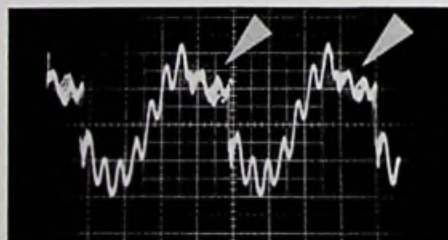
Bild 7: Beim Modell MC-1 sind 10 mN Auflagekraft besonders dann kritisch, wenn die Schallplatte einen Höhenschlag aufweist (Verzerrungseinsatz: s. Pfeil)
