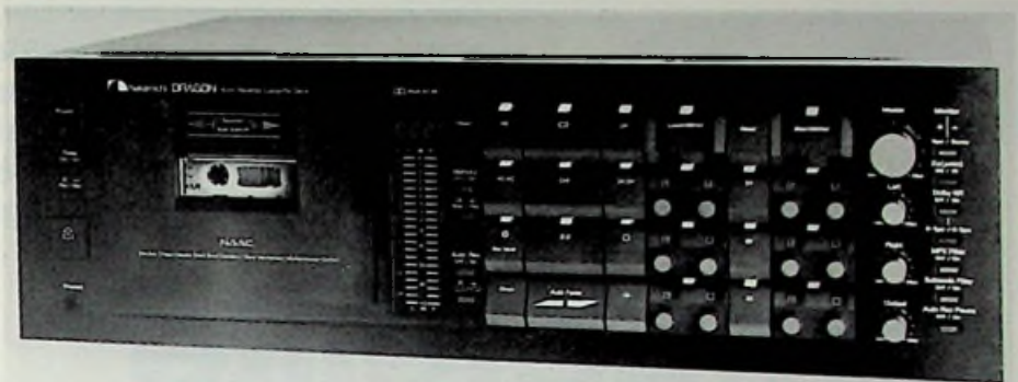
Bild 2: Auto Reverse Cassettendeck „Dragon“ mit automatischer Anpassung des Wiedergabekopfspaltes an die Winkelstellung des zur Aufzeichnung benutzten Aufsprechkopfes (Nakamichi-Pressbild)
