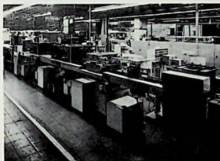
Bild 2: Die vollautomatische Simultan-Chip-Bestückungsanlage arbeitet mit drei Bestückungsköpfen und kann 450 Bauteile in etwa 10 s setzen
