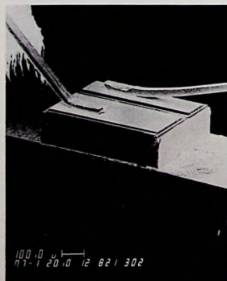
Bild 2: Gallium/Aluminiumarsenid-Laserdiode mit integrierten Monitordioden (Siemens-Pressbild)
